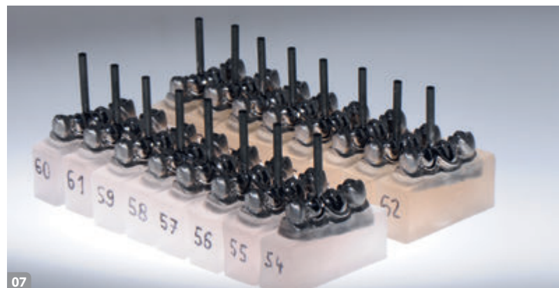
2 3-D-gedruckte Klammern aus rückstandslos verbrennbarem Kunststoff für die Lost-wax-Technik | 3a & b, 4 Einbetten und Gießen der 3-D-gedruckten Klammern | 5 Generierung der Stützstrukturen für die additive Fertigung mittels Direct Metal Laser Sintering (DMLS) | 6 Bauplattform nach dem additiven Bauprozess der Klammern | 7 Abzugsmodelle mit 16 lasergesinteren Klammern
