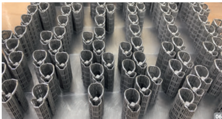
2 3-D-gedruckte Klammern aus rückstandslos verbrennbarem Kunststoff für die Lost-wax-Technik | 3a & b, 4 Einbetten und Gießen der 3-D-gedruckten Klammern | 5 Generierung der Stützstrukturen für die additive Fertigung mittels Direct Metal Laser Sintering (DMLS) | 6 Bauplattform nach dem additiven Bauprozess der Klammern | 7 Abzugsmodelle mit 16 lasergesinteren Klammern
