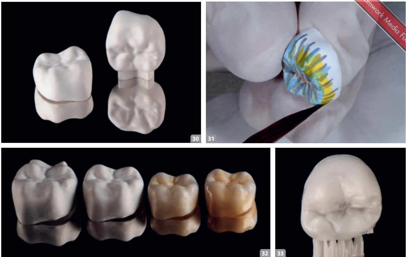
30 Vollanatomische Seitenzahnkronen aus Zirkonoxid nach dem additiven Bauprozess in der „Grünlings“-Phase (organischer Binder ist noch enthalten) | 31 Individuelle Einfärbung der Krone in der „Weißlings“-Phase | 32 Grünling – Weißling – dichtgesintert – Malfarben-/ Glasurmassebrand (von links nach rechts) | 33 Exakte Wiedergabe der Kauflächen mit scharfer und natürlicher Darstellung der Fissuren
