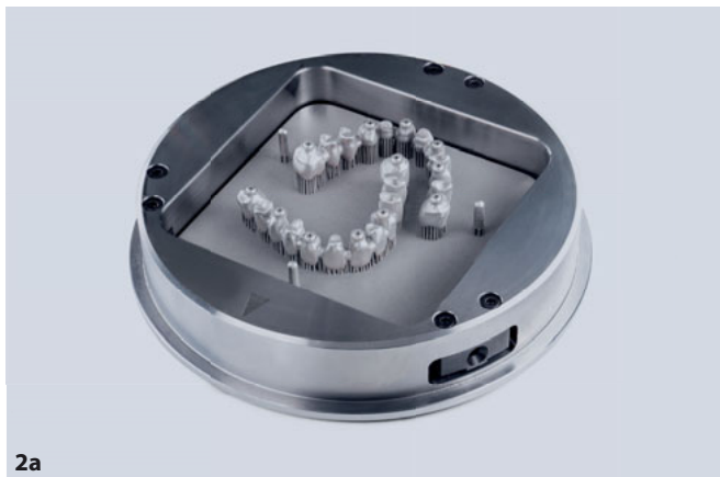
Abb. 1 Hybrid-Musterteil: Implantatgeometrie a unbearbeitet und b bearbeitet. Abb. 2a und b Hybrid-Musterteil im Datron-Halter: fertige Bauplattform und Ansicht in der CAM Software hyperDENT.
