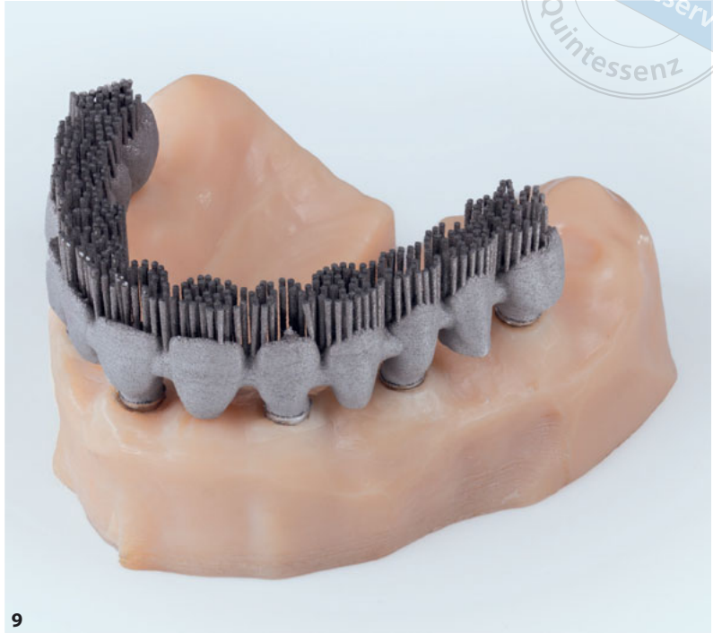
Abb. 8 Hybridbearbeitung auf dem Datron D5. Abb. 9 Hybrid-Musterteil auf dem Modell.
